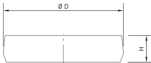
Tabella 1.33 Tappi per i fori di montaggio delle guide profilate
