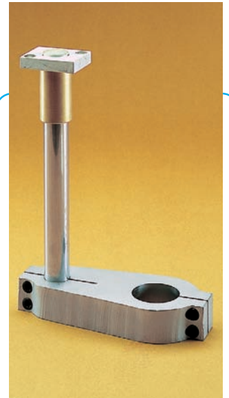
Cod. RP Gruppo antirotazione completo di staffa, stelo antirotante, boccola di guida, coperchio boccola. Code RP Anti-rotation group complete with bracket, anti-rotation rod, guide bushing and bushing cap.
