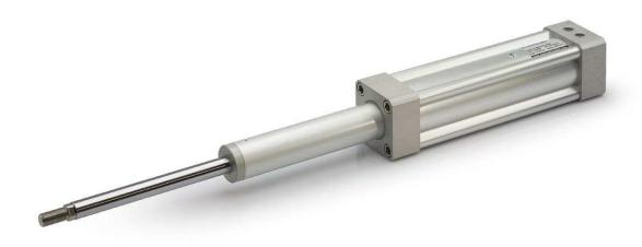
I cilindri telescopici della serie "TL" sono degli attuatori lineari che effettuano una corsa maggiore dell'ingombro del cilindro interamente chiuso. Il concetto costruttivo di tali cilindri è quello di inserire più cilindri in uno, pertanto la scelta viene effettuata in funzione della forza di spinta dell'ultimo sfilamento (l'alesaggio dello sfilo più piccolo).
