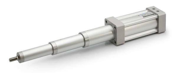
I cilindri telescopici della serie "TL" sono degli attuatori lineari che effettuano una corsa maggiore dell'ingombro del cilindro interamente chiuso. Il concetto costruttivo di tali cilindri è quello di inserire più cilindri in uno, pertanto la scelta viene effettuata in funzione della forza di spinta dell'ultimo sfilamento (l'alesaggio dello sfilo più piccolo).
