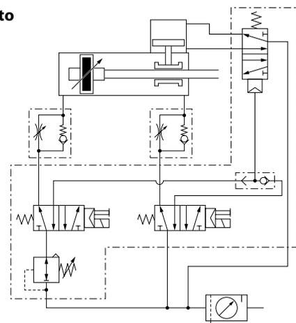
**DISPOSITIVI DI BLOCCO ALBERO - ROD LOCKING DEVICE**
